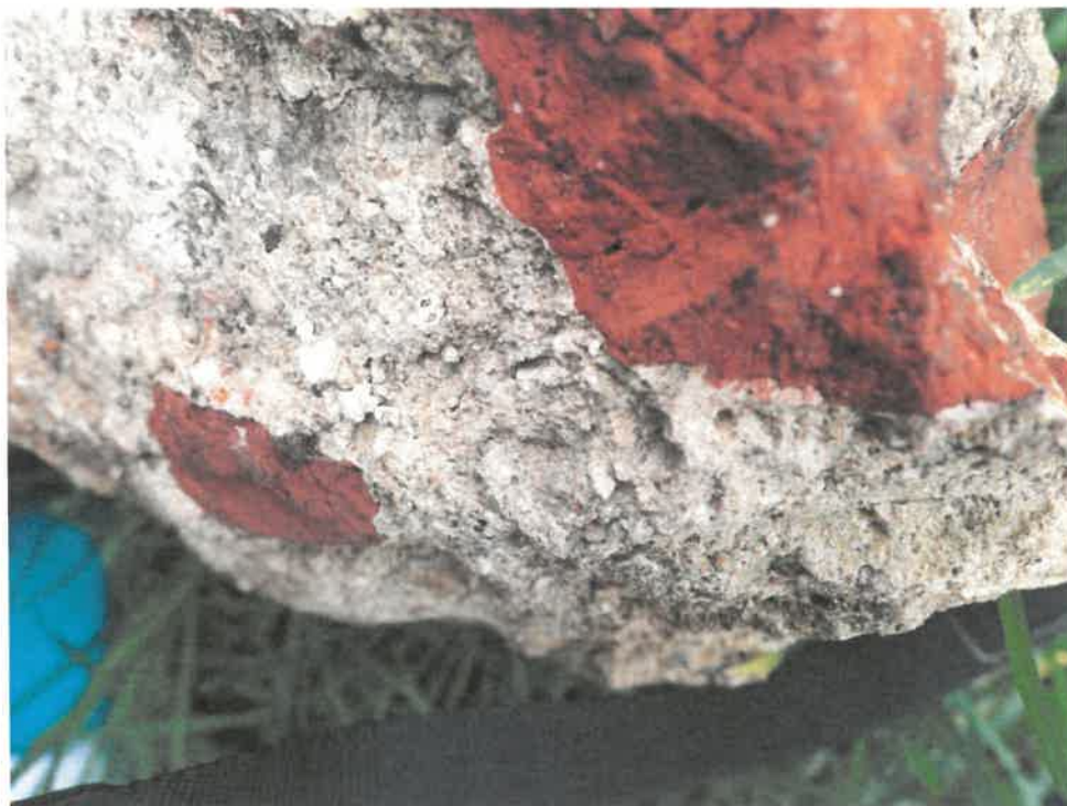
Fot. 10. Zbliżenie fragmentu gruzu z wykopu z widoczną zaprawą o bardzo dużej wytrzymałości mechanicznej, silnie spajającą cegły.
