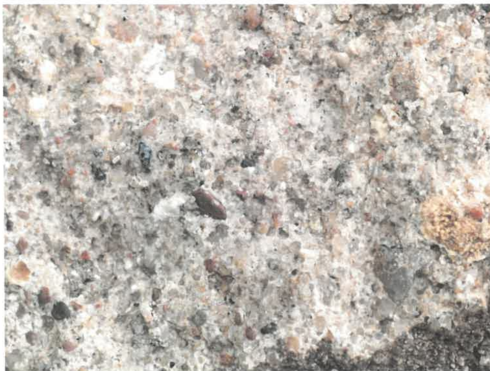
Fot. 11. Makrofotografia powierzchni zaprawy pokazująca jej zwięzłą strukturę, wypełniacz i bazalne spoiwo.
